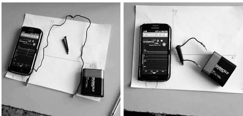
Figura 4. Esperienza relativa alla bobina per la misura del campo magnetico.
